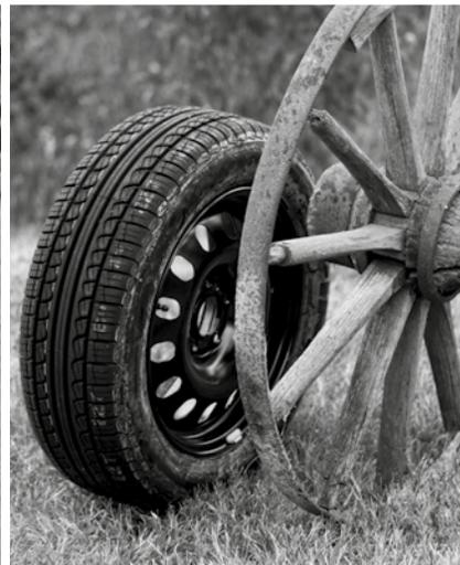
di un procedimento in cui la gomma veniva trattata con lo zolfo e acquisiva resistenza meccanica e stabilità chimica, generando miglioramenti in termini di flessibilità, impermeabilità e resistenza a varie temperature. Nel corso degli anni questo processo è diventato sempre più sofisticato.
